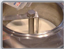
Vasca di produzione verticale permette di controllare la trasformazione della miscela durante tutta la fase di lavoro. Vertical tank allows you to check state of mixing throughout the entire production cycle
